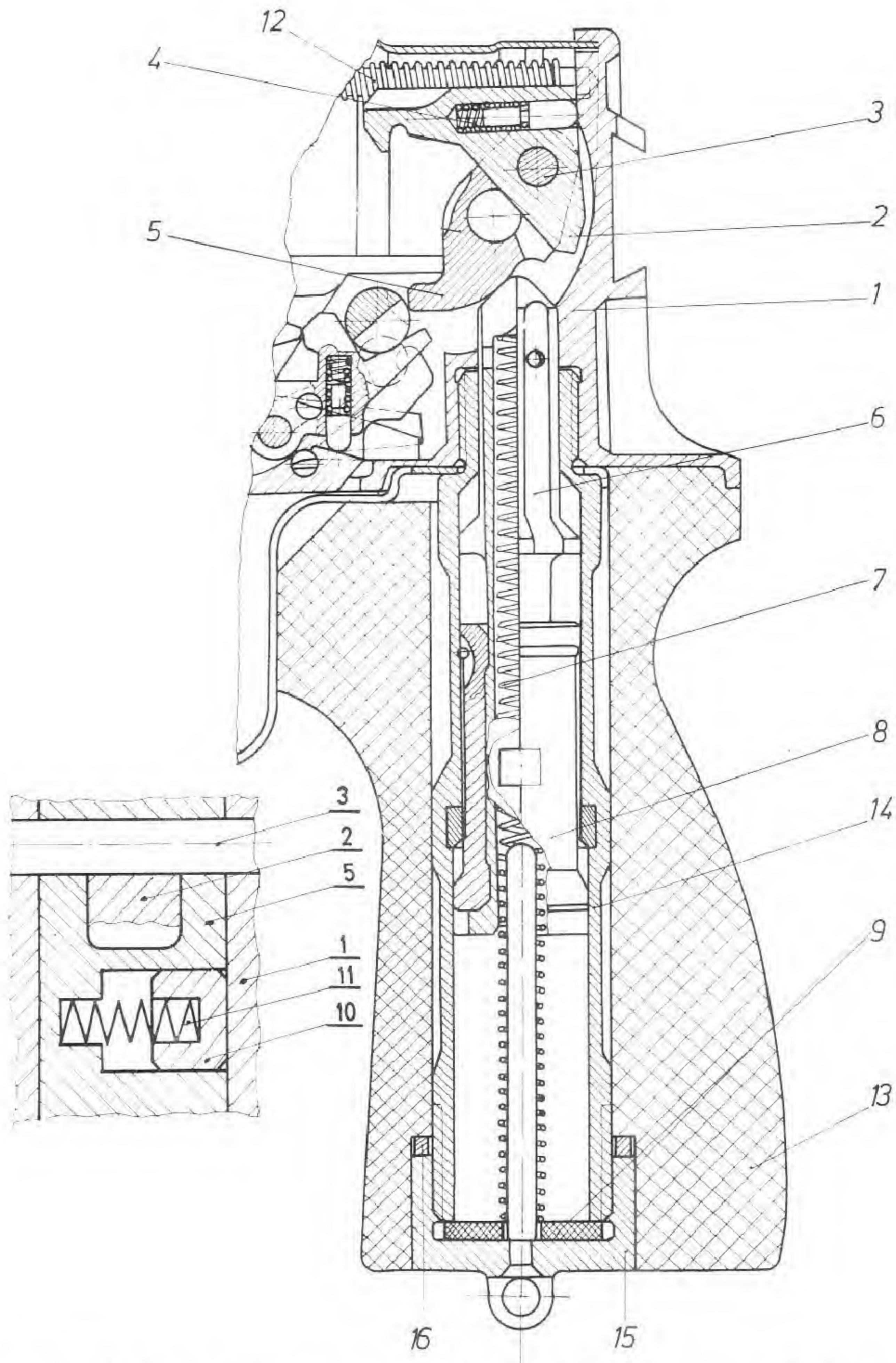
Sl. 19- Mehanizam za usporenje brzine gađanja (položaj delova pre opaljenja metaka):
